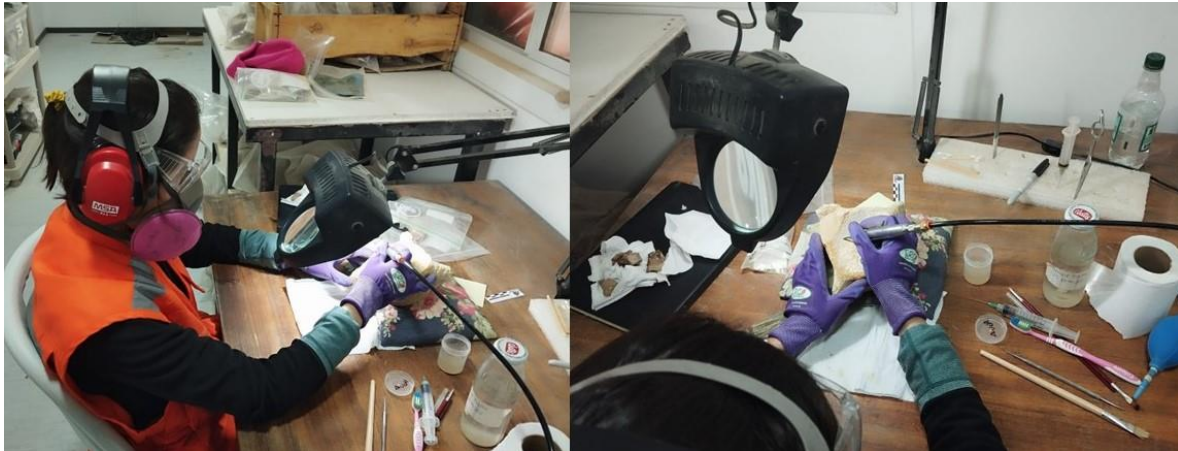
Figura 11. Preparación neumática de material paleontológico: Izq: Estación de trabajo con conexión a red de aire comprimido mediante manguera ¼ desde compresor. Der: Detalle de airscriber tipo ARO (Paleotools ®). Nótese que el personal preparador debe protegerse con el EPP adecuado para esta actividad. Antiparras, protección auditiva tipo Orejera y mascara media cara con filtro partículas y vapores volátiles
