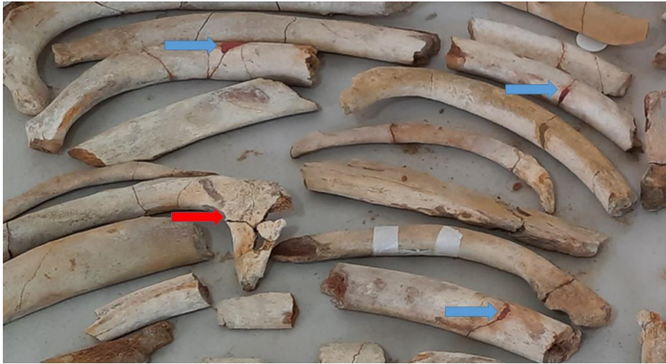
Figura 8. Ejemplos de material fósil estabilizado con cera bee-wax. Flecha azul: Zonas reconstruidas con cera BeeWax. Flecha roja: Zona reconstruida a partir de fragmentos utilizando “gel de paraloid” (Solución de paraloid B-72 en acetona con concentración mayor al 50% utilizado generalmente como pegamento reversible)
